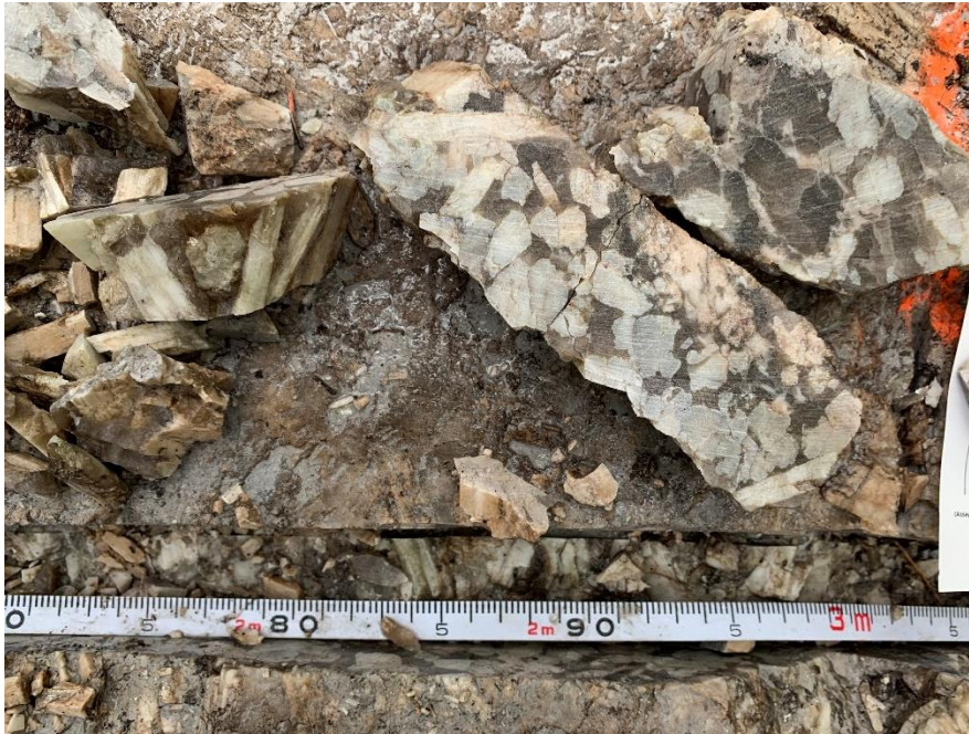
Foto 5: Nahaufnahme einer Probe aus dem zersägten Schlitzprobenmaterial. Beachten Sie die grobkörnigen Spodumenkristalle.
